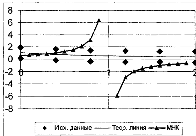
Рисунок 2 – Теоретическая регрессия y = 1/(1 + x) и эмпирическая функция регрессии \hat{y} = 1/(1,63218-1,63863x) , найденная по МНК после линеаризации
